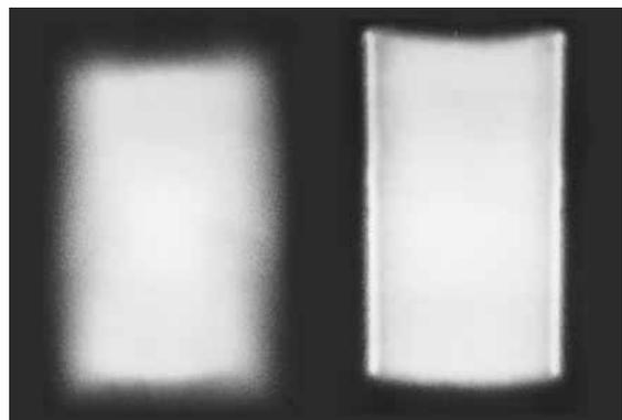
Sprühbild: links neue LP Düse, rechts normale PAA Düse
