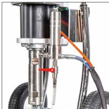
Standardmässig mit Hochdruckfilter
